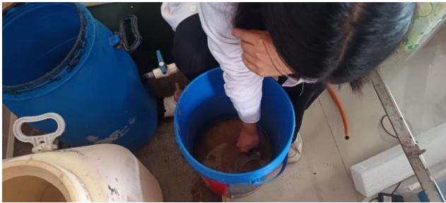
Figura 2 y 3. Adición de materiales y solución de materia prima al biodigestor.
