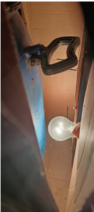
Figura 7. Introducir fuente de calor mediante la luz de un foco de alto voltaje.
